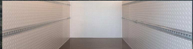
**Kunststoff-Bodenbeschichtung.** Als verschleißfeste, rutschsichere und absolut dichte Oberflächenbeschichtung.
